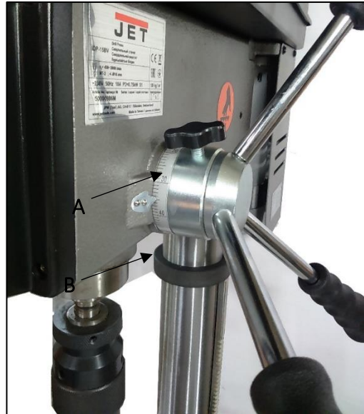
Рисунок 8-1. Регулировка ограничителя глубины сверления
